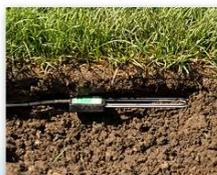
2) Instale o sensor de 7,5 – 12,5 cm de profundidade
